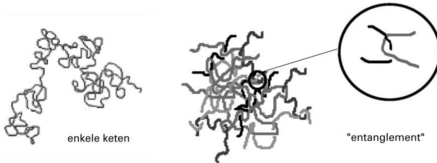
Figuur 1.2. Schematische voorstelling van kluwen polymeer ketens die onderling verknoot zijn.
