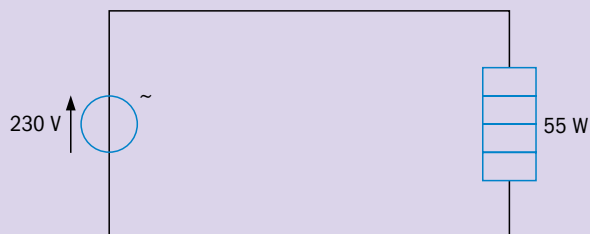
FIGUUR 1.22 Soldeerbout 55 W
